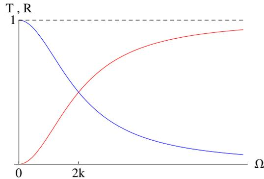
Figura 1: Transmisión (en azul) y reflexión (en rojo) para una barrera delta  $V(x) = \frac{\hbar^2}{2m}\Omega$ .
