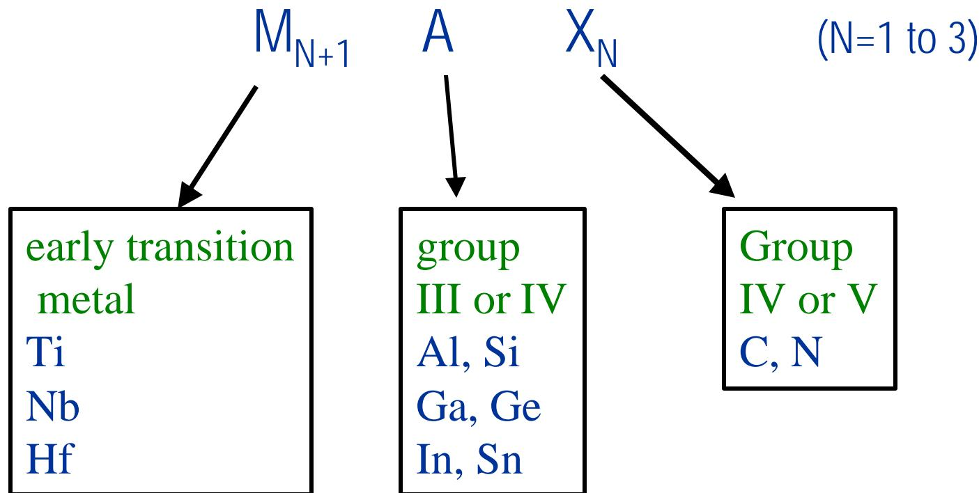
Ex.:  $\text{Ti}_2\text{AlC}$ ,  $\text{Ti}_3\text{SiC}_2$ ,  $\text{Ti}_4\text{AlN}_3$
